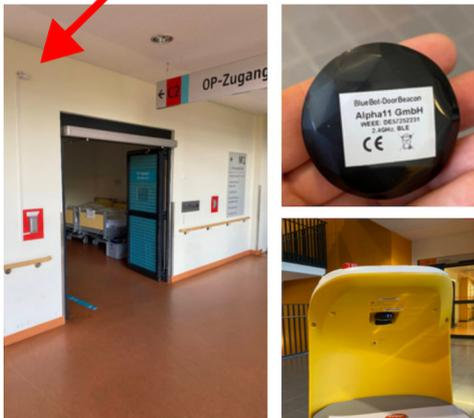
**BlueBot-DoorBox** erkennt Roboter aus einigen Metern Entfernung (ca. 5-20m)
